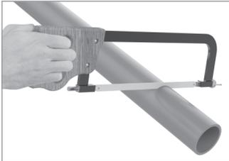
**Passo 1:** Corte o tubo com o auxílio de uma ferramenta, mantendo a sua ponta plana;
