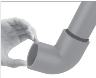
**Passo 11:** Esse processo deve criar um anel com material excedente. Com o auxílio de uma estopa ou de um pano, retire o excesso do adesivo para agilizar o tempo de cura.
