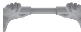
3 - Utilize duas Luvas soldáveis CPVC e coloque-as primeiramente nas extremidades do novo trecho de tubo soldando primeiramente na linha já existente para depois soldar no novo trecho.
